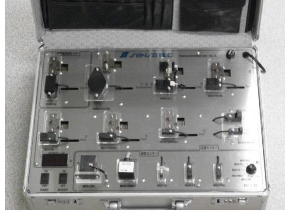
金属を検出する「近接センサ」人の体を検出する「静電容量センサ」磁石を検出する「磁気センサ」などなど・・・他にもいろいろなセンサがありますので、実際に触ってみて何に反応するのか体験してみよう！
