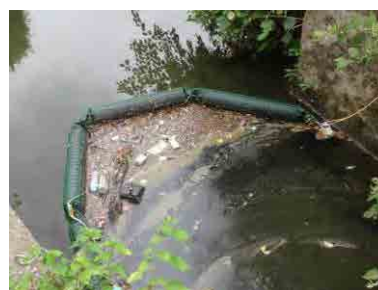
川のごみのモニタリングを行っている雑水川のダストフェンス
