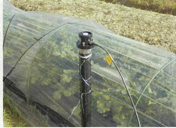
写真1. 光量子計の設置状況 棒の先端(1m 高さ)に固定。
