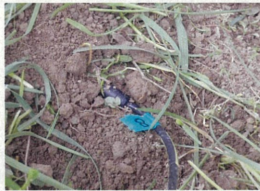
写真2. 土壌水分・温度計の設置状況 左は小型ハウス内の土壌、右はハウス外の土壌に挿入した状況
