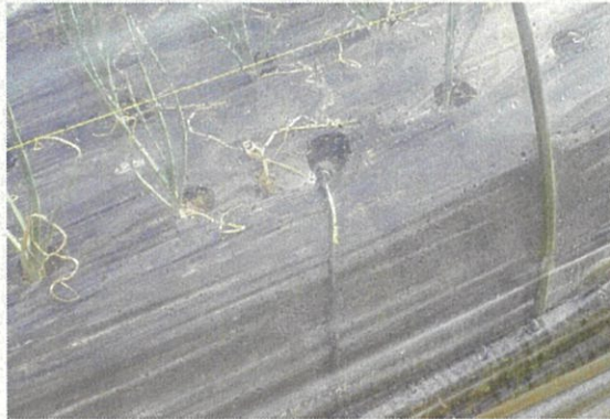
写真2. 土壌水分・温度計の設置状況 左は小型ハウス内の土壌、右はハウス外の土壌に挿入した状況
