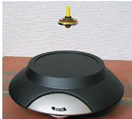
\*ジャイロ効果とは・・・「回転軸の向きは空間に対して一定である」という原理で回転しているものの軸を動かそうとすると、元に戻す力がはたらきます。
