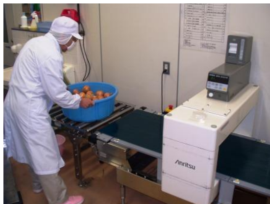
金属探知機による検収作業
