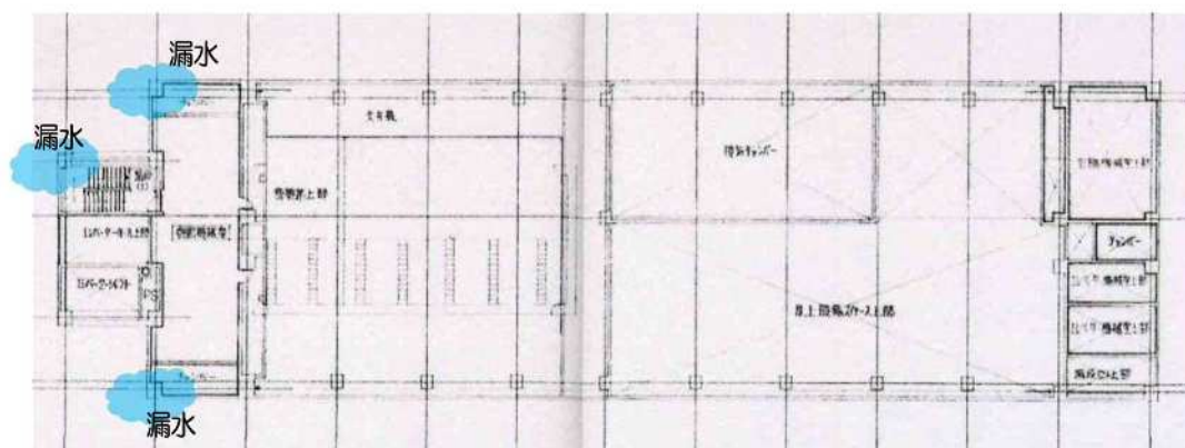
屋根 (1) より10階空調機械室へ漏水が確認される
