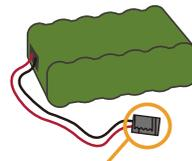
用聚氯乙烯绝缘带缠绕连接器部分
