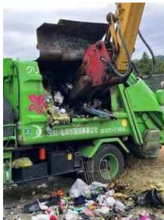
(荷室からのごみ排出状況)
