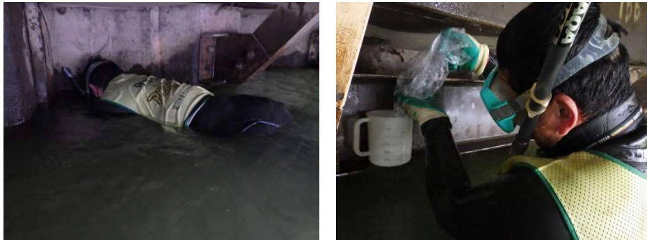
図 1-5-4 湧水定量調査の様子（左：採水、右：計測）（撮影日 H29. 11. 14 成果品より）
