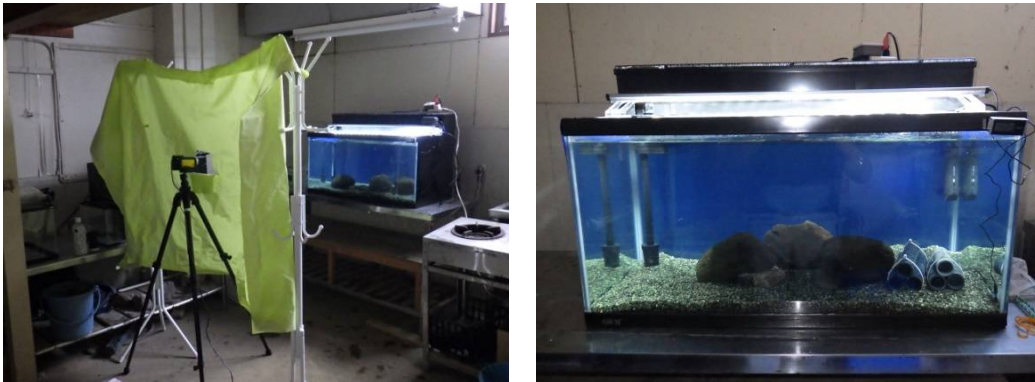
図 2-2-2 左：設置した水槽とカメラの位置、右：設置した水槽
