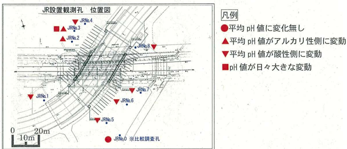
図 2-3-16 セメントミルク注入中の pH 値の変動の特性
