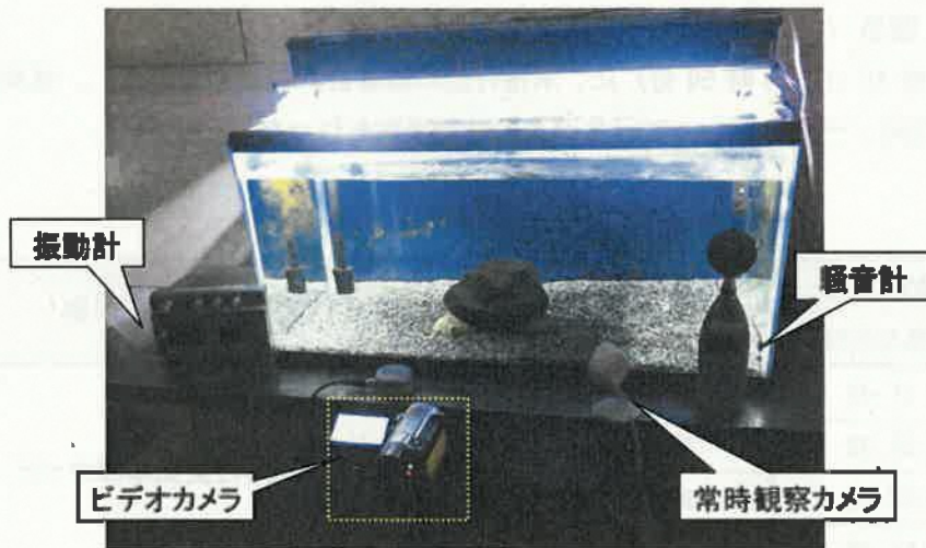
図 10 工事中1回目挙動観察風景（騒音・振動）
