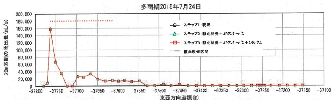
図 2-(2)-20 右岸全区間の地下水湧水量 解析 (スタジアム付近地下水動水勾配最大時：多雨期)
