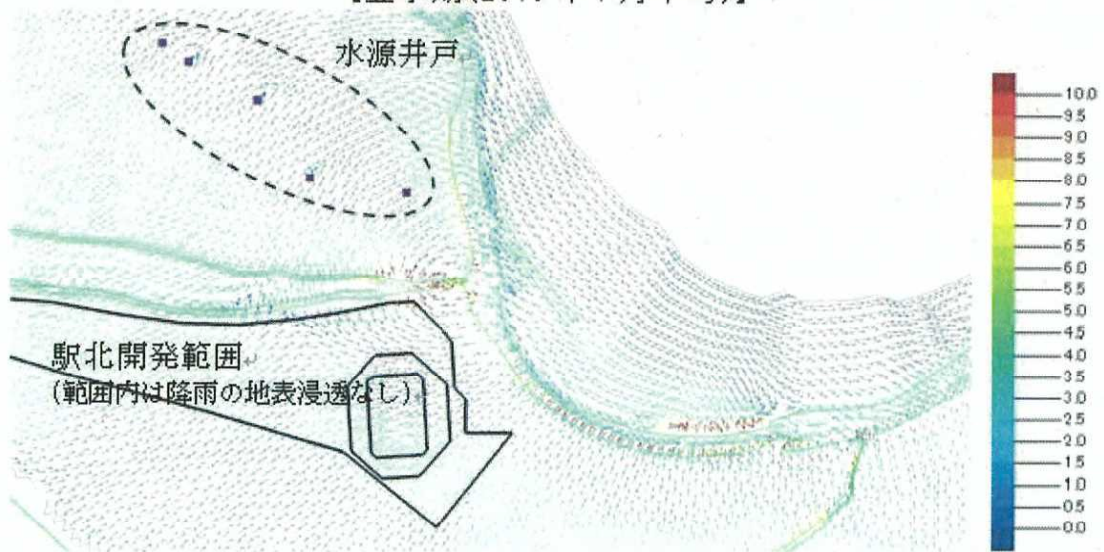
図-5-6 現況の地下水位再現計算結果 (ステップ3 【ケース2】のAg層の流速ベクトル、単位：m/d)
