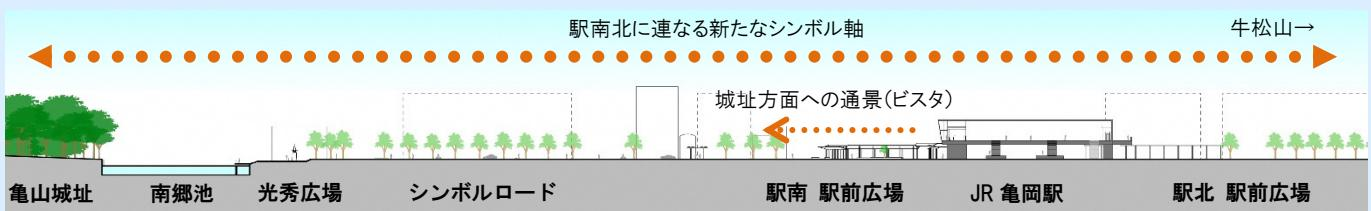
駅前通りの中央帯撤去と道路空間上空の電線類を地中化し、駅前通りから城址方面への通景（ビスタ）の確保と歩道の拡幅を行います。
