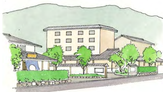
こう配屋根の形状を示したパラペットの設置
