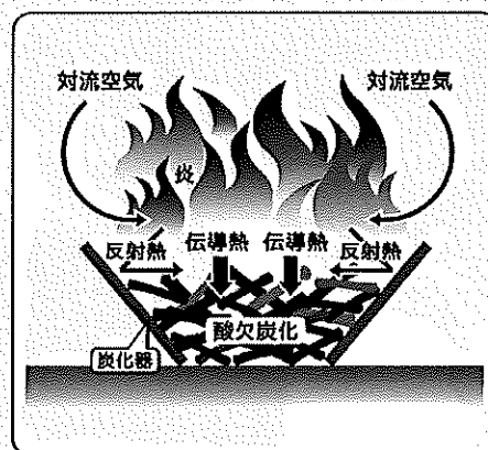
無煙炭化器の仕組み
