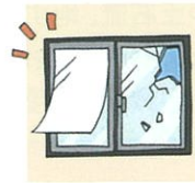
窓ガラス破損飛散防止対策
