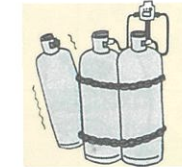
プロパンガスボンベの転倒防止、安全機器の設置状況対策
